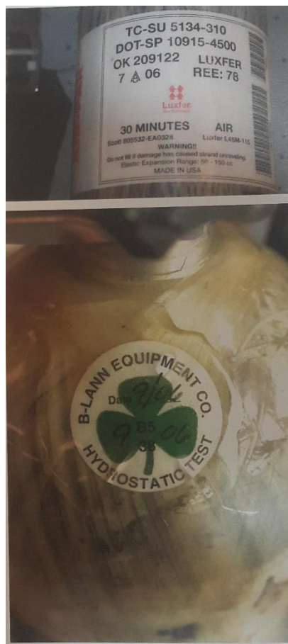
شکل (۶-۱۷) بسته به نوع مواد، لازم است سیلندرهاى SCBA هر سه تا پنج سال آزمایش هیدرواستاتیک شوند.
