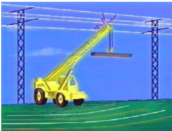
شکل 8. خطر برخورد با سیم برق هوایی
