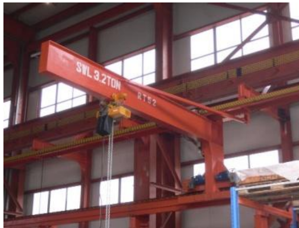
شکل 3. درج SWL روی بازوی جرثقیل
