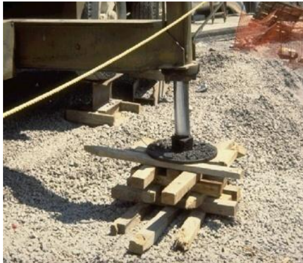
شکل 7. استقرار نا ایمن جک تعادلی
