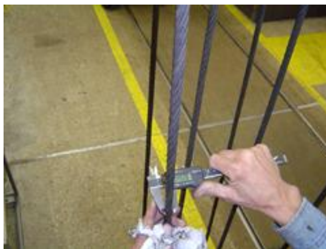
شکل 16. اندازه گیری قطر سیم بکسل
